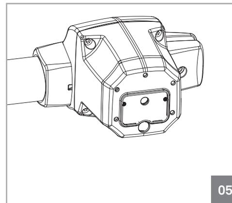
01 • Desapertar os parafusos que fixam a Parte de Baixo com a Parte do Meio.
